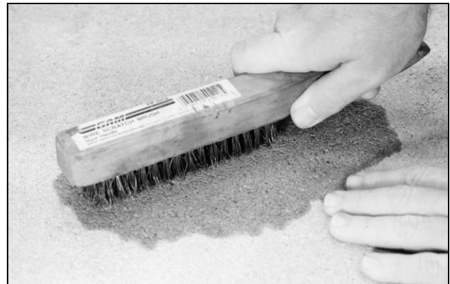
Abb. 1 - Konditionieren der Oberfläche für die DMS-Installation
